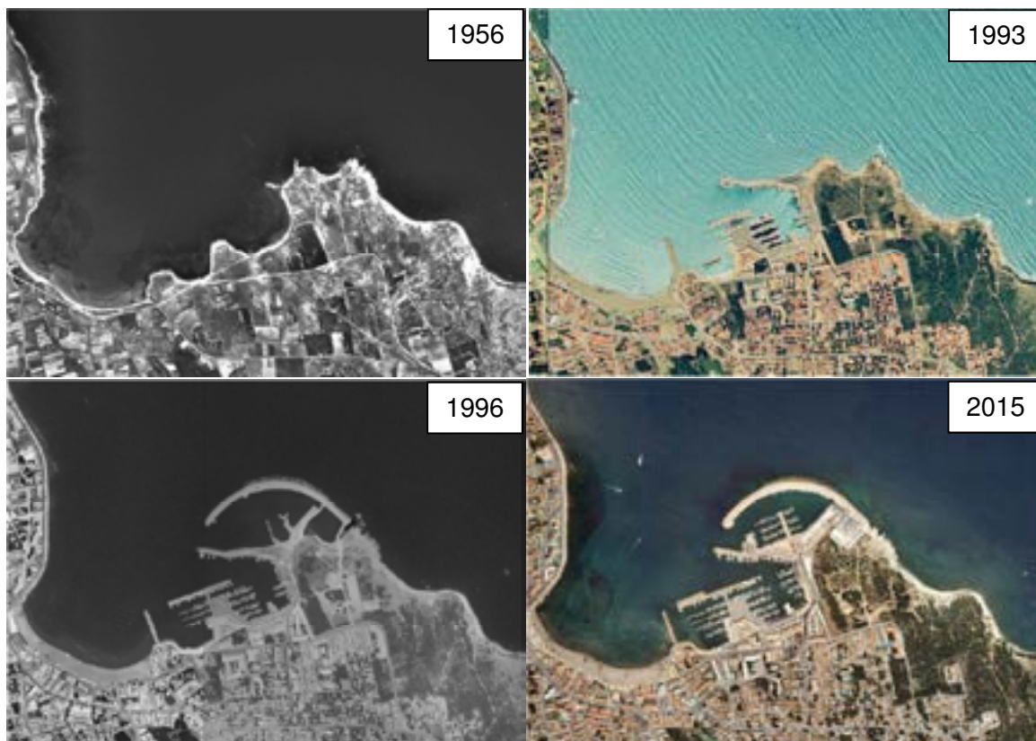
Figura 8: Comparativa entre les fotografies aèries de l'any 1956, 1993, 1996 i 2015 on s'observa l'evolució temporal del rebliment antròpic per a la construcció del port de l'Escala.
