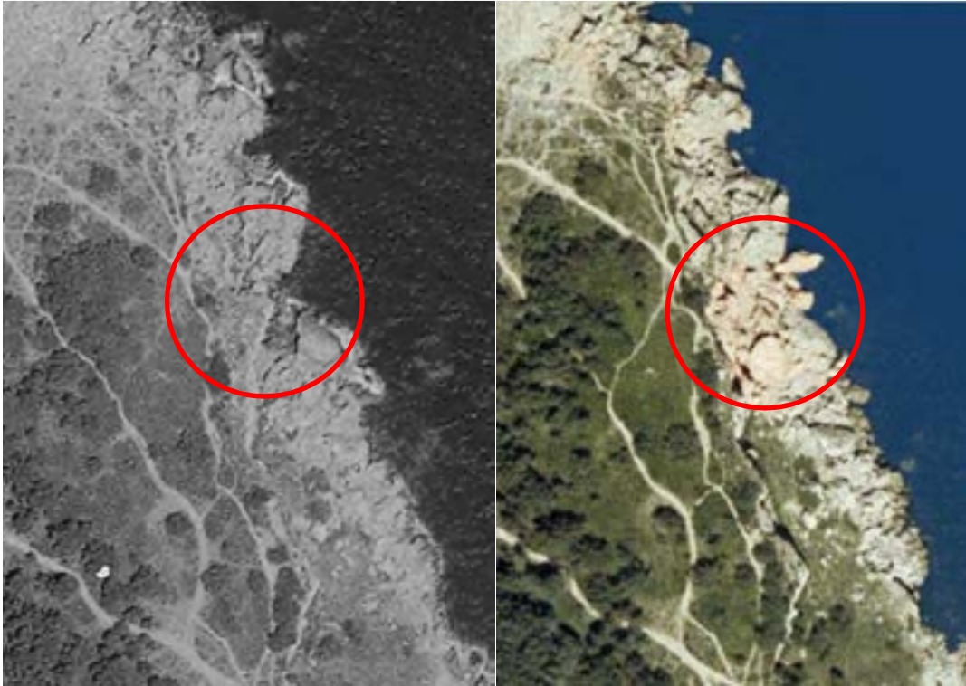
Figura 7: Comparativa entre les fotografies aèries de l'any 1996 (esquerra) i 2002 (dreta) on s'observa l'abans i el després d'una de les esllavissades de la cala de l'Illa Mateua.
